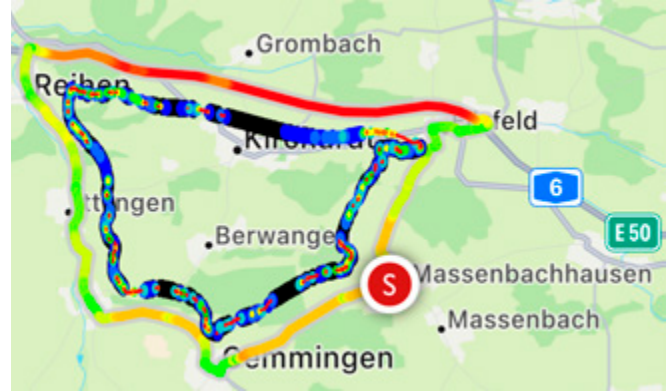
BILD 1 Strecke und berechneter Reifenverschleiß auf der Strecke (© twms)
