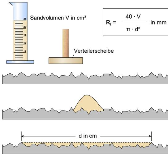
Bild 1: Das Prinzip des Sandflächenverfahrens
