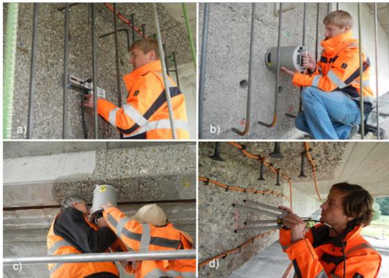
Bild 9: Laser-Rauheitsmessgeräte im Baustelleneinsatz: a) Profilometer, b) und c) ELAtextur®-Gerät, d) Linienlaser
