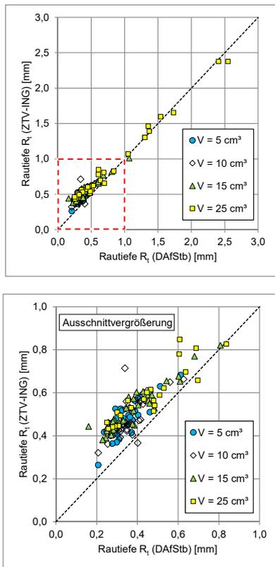
Bild 5: Vergleich der Rautiefen  $R_r$  bei Prüfung nach DAfStb-Rili SIB [1] und ZTV-ING [2]
