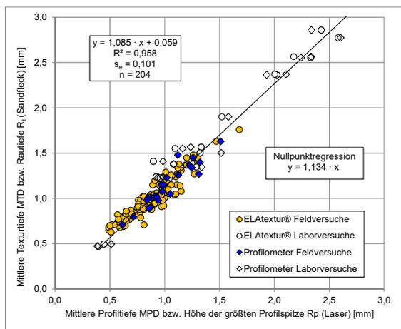
Bild 10: Korrelation der Laser-Profilmessungen mit den Ergebnissen des Sandflächenverfahrens
