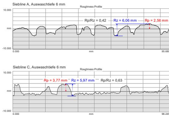
Bild 12: Bei gleicher Auswaschtiefe ( $R_z$ ) sehr unterschiedliche Bewertung positiver (Sieblinie C) und negativer Texturen (Sieblinie A) mit dem Parameter  $R_p$
