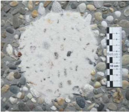
**Bild 2:** Beispiel eines Sandflecks für die Bestimmung der Rautiefe  $R_t$  mit Abweichungen von der Kreisform bei grobrauer Oberfläche
