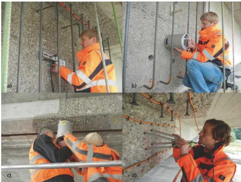
**Bild 10: Laser-Rauheitsmessgeräte im Baustelleneinsatz: a) Profilometer, b) und c) ELAtextur®-Gerät, d) Linienlaser**
