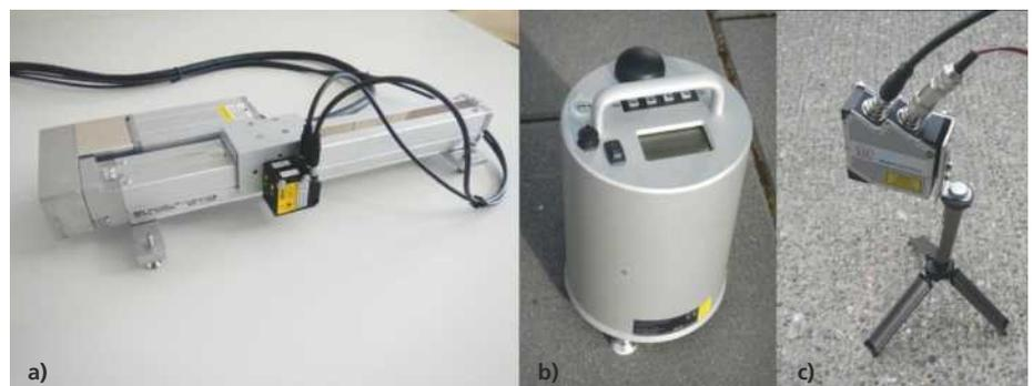
**Bild 9: Mobile Laser-Rauheitsmessgeräte: a) Profilometer, b) ELAtextur®-Gerät, c) Linienlaser**
