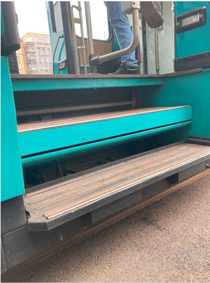
Abbildung 21 – Einstieg mit Stufen beim P-Wagen – logistischer Nachteil im Vergleich zum S- oder R-Wagen
