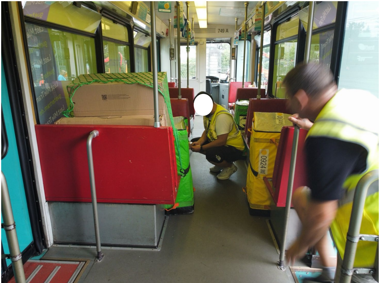
Abbildung 22 - beispielhafte Befestigung der Transporttaschen und Oversize Packages in der VGF Gütertram
