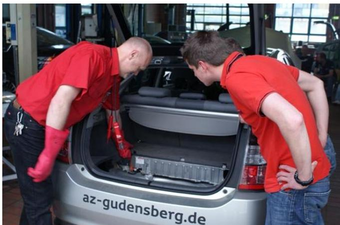
Vor Reparatur oder Demontage von Komponenten des HV-Systems, erfolgt durch entfernen des Service-Disconnects ein Spannungsfreischnalten.
