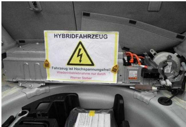
Nachdem die Spannungsfreiheit des Hochvoltsystems überprüft wurde, wird dies durch Hinweise am Fahrzeug kenntlich gemacht.
