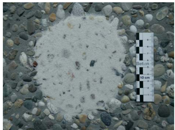
Bild 1: Sandflächenverfahren nach DAfStb Rili SIB [1], Kornoberflächen mit Sand bedeckt
