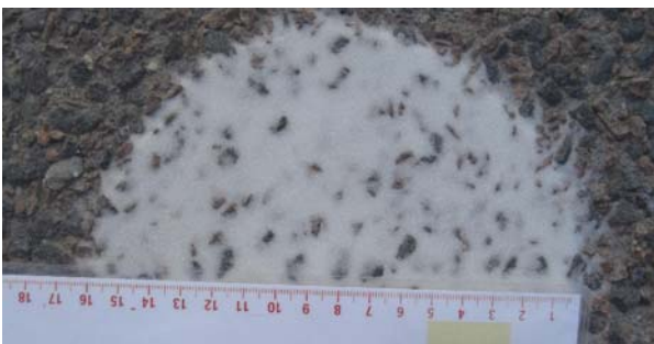
Bild 8: Zerfaserter Rand bei der Prüfung mit Glaskugeln nach DIN EN 13036-1 [8] (Foto: Thomas Schmidt)
