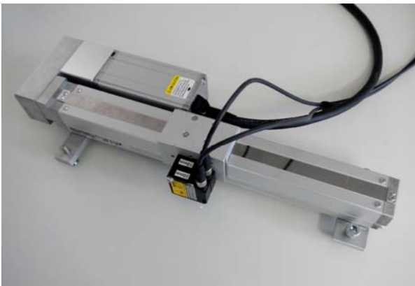
Bild 4: Profilometer FH FFM
