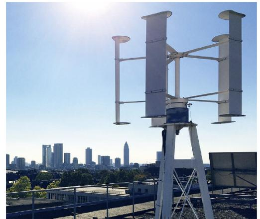
Kleinwindkraftanlage auf dem Dach der Frankfurt University
