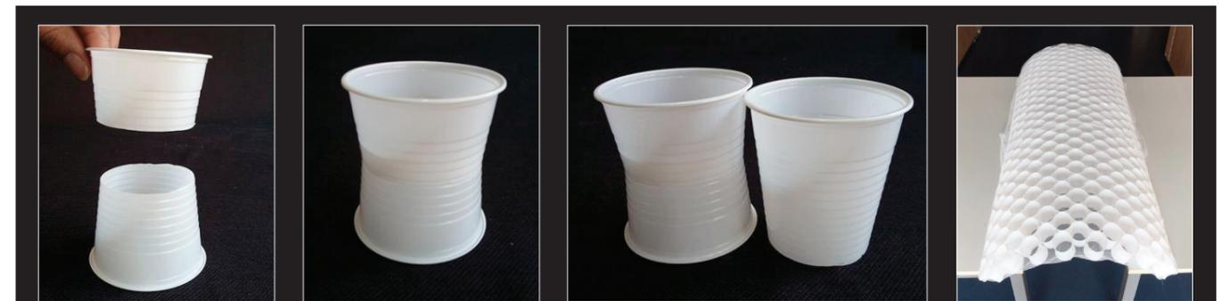
Alica Erzgräber, Rokeya Chowdhur: Recycling Dachelement, Schalenstruktur unter Nutzung der Geometrie gebrauchter Plastikbecher in Kombination mit Textilmembran
