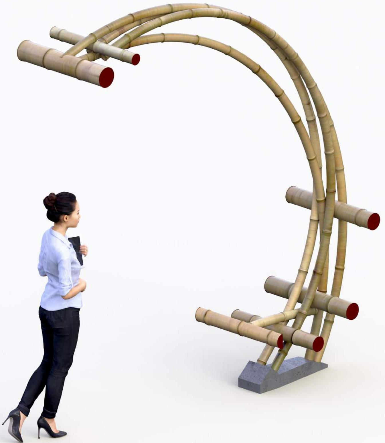
ABBILDUNG 11: GEBOGENER FACHWERK-TRÄGER, SCHEMATISCH
