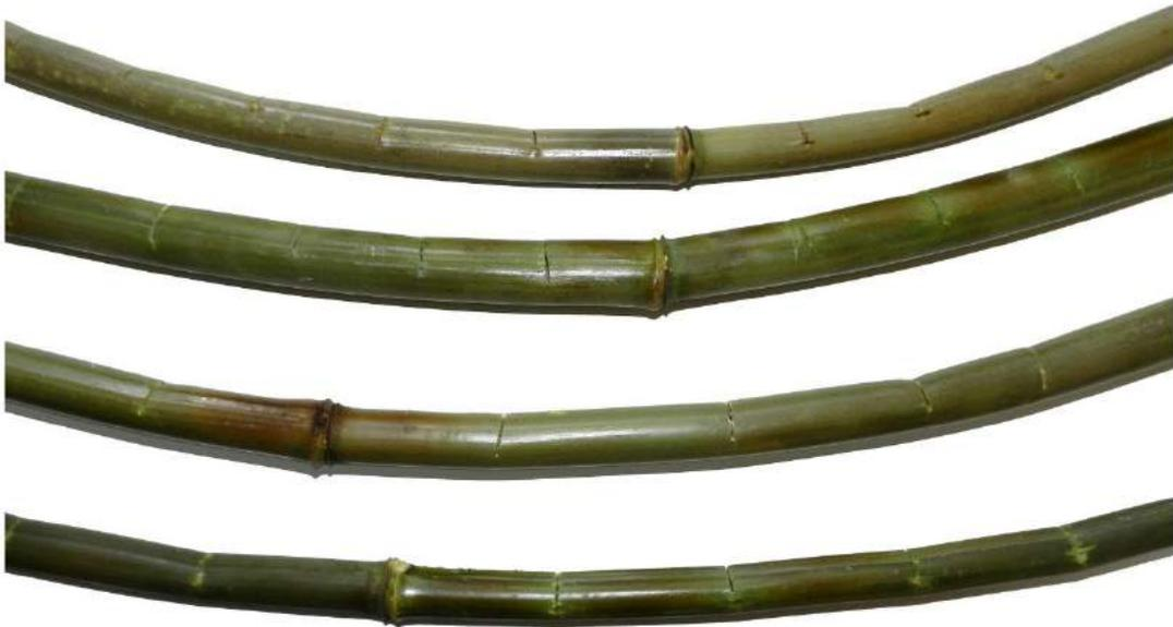
Kombination aus Schlitzten und Erhitzen mit Heißluftföhn,
