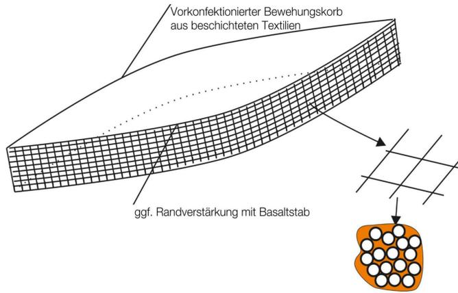
Formstabilität der Bewehrung wird durch Beschichtung erreicht
