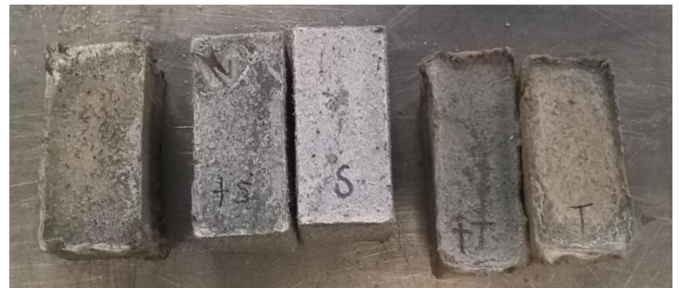
v.l.n.r. Referenzkörper, Körper hergestellt mit Schalung aus: raumtemperierter kinetischer Sand, gefrorener kinetischer Sand, raumtemperierter Ton, gefrorener Ton
