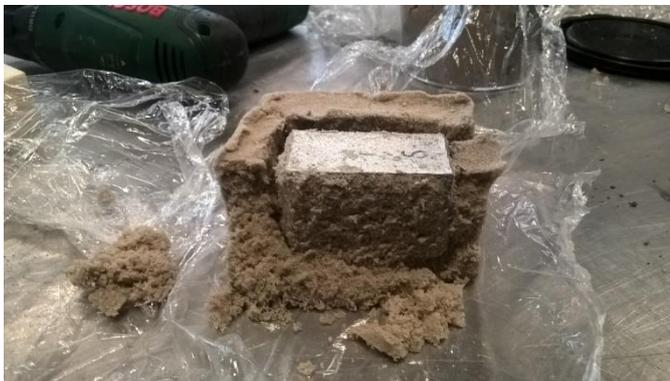
Abbildung 11 Probekörper vier ausgeschalt
