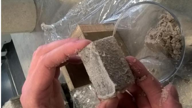
***Probekörper vier – Sand-Schalung (0,2°C Oberflächentemperatur)***
