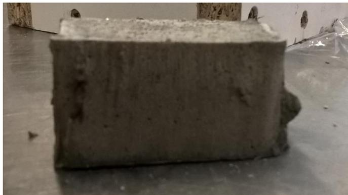
***Probekörper eins – Ton-Schalung (20,8°C Oberflächentemperatur)***
