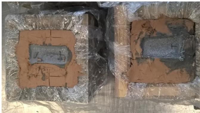
Abbildung 5 Probekörper eins beim Ausschalen
