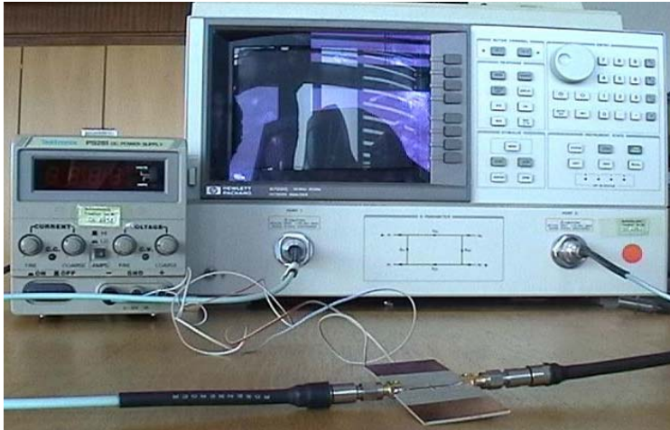
Bild 7.1-a: Messtechnik mit Hilfe der Netzwerkanalysator
