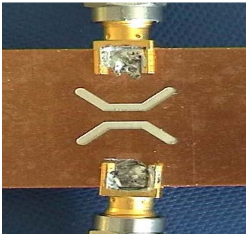
Bild 7.5-c: BottomLayer der Mikrostreifen-Schlitzleitung (knick)
