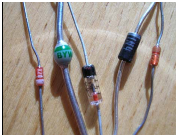
Abbildung 1: Aufbau einer Diode [3]
