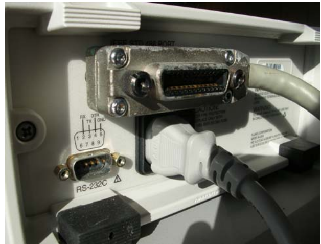
Abbildung 22: GPIB-Schnittstelle am Fluke-Messgerät [3]
