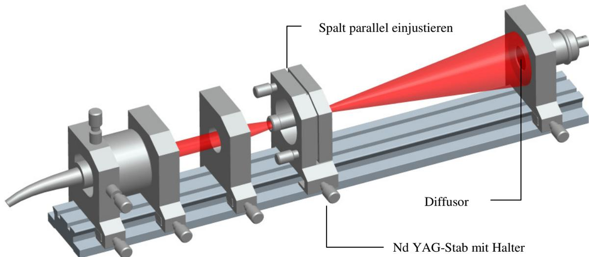
Abb. 5 Aufbau zur Absorptionsmessung
