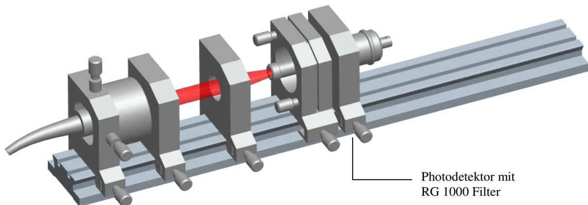
Abb. 6 Aufbau zur Lebensdauerermessung
