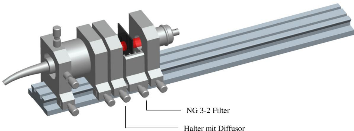
Abb. 2 Versuchsaufbau zur Messung der relativen Ausgangsleistung des Diodenlasers
