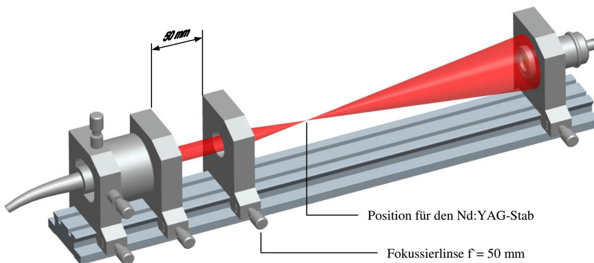
Abb. 4 Versuchsaufbau mit eingesetzter Fokussierlinse
