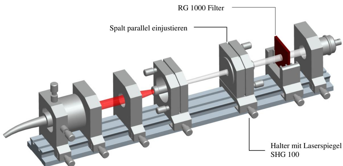
Abb. 7 Versuchsaufbau zur Messung der rel. Ausgangsleistung des Nd:YAG-Lasers
