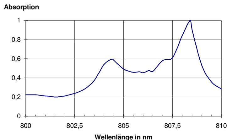
Abb. 3 Absorptionsspektrum des Nd YAG-Kristalls
