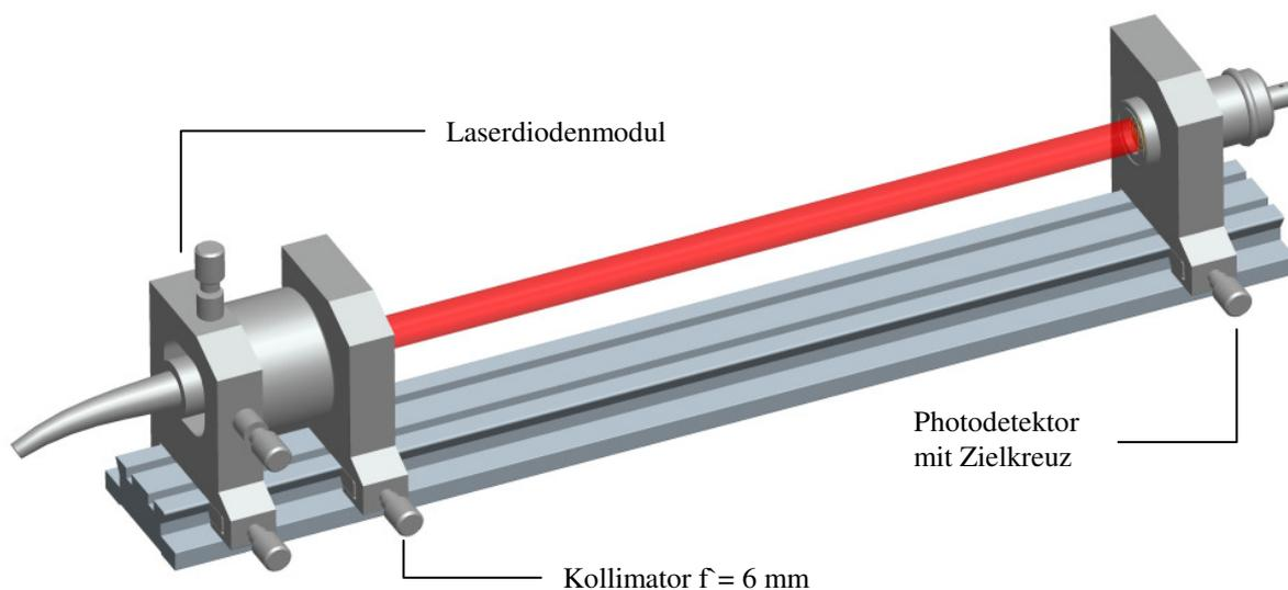
Abb. 1 Laserdiode mit Kollimator
