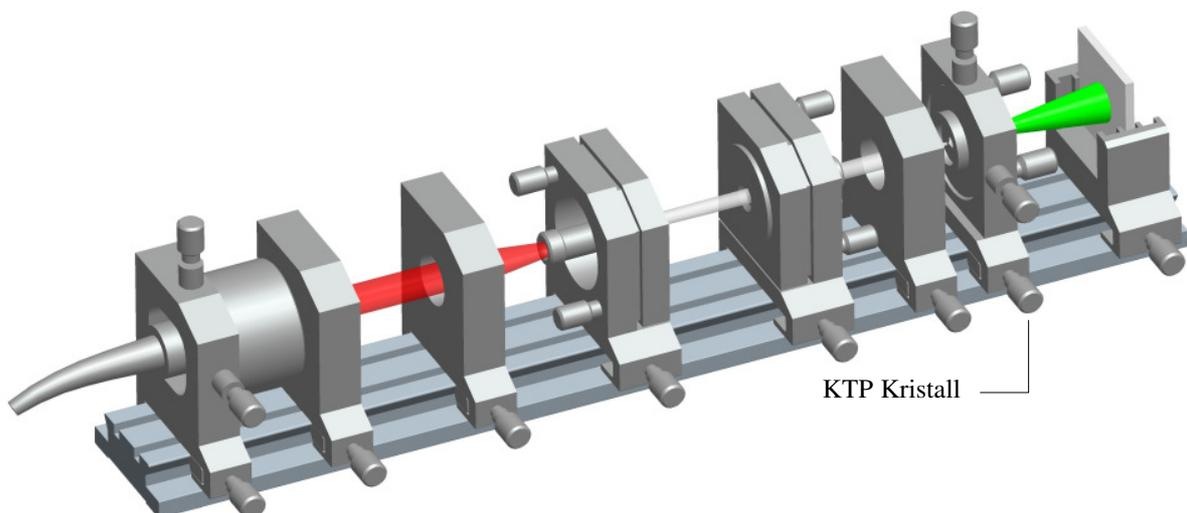
Abb. 10 Aufbau zur resonatorexternen Frequenzverdopplung
