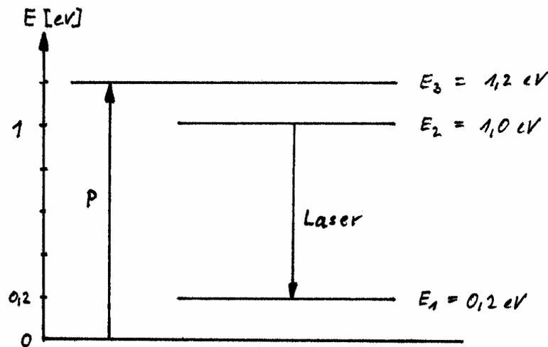
Das aktive Medium befindet sich in einem Resonator und die Brechzahl ist 1.
