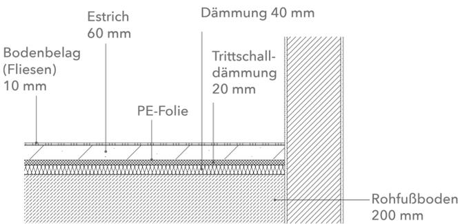
Detail Bodenaufbau Duschbereich | M 1:5
